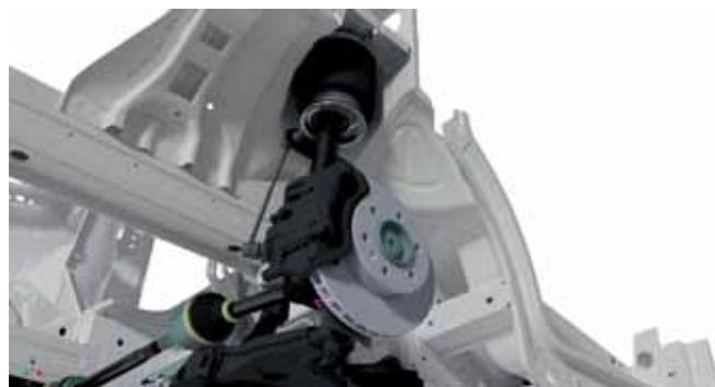
Die Vorderachse des Mercedes Sprinter kann bei Goldschmitt mit einer Vollluftfederung ausgestattet werden.
