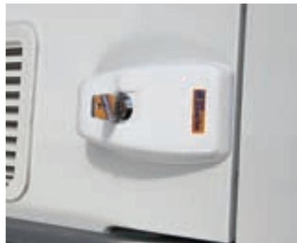
HEOSafe von Security: Montiert an Schiebetüre – geschlossen und offen
