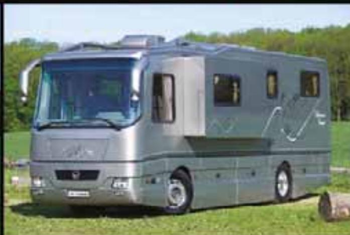
Der **Volkner Mobil Performance Compact** ist der kompakte Bruder des **Volkner Mobil Performance**. Das Heckmotor-Busfahrgestell verfügt über 290 PS, die Gesamtlänge beträgt 10m bis 10,4m. In der PKW-Mittelgarage steht wahlweise ein Mini-Cooper oder ein Smart und Fahrräder.
