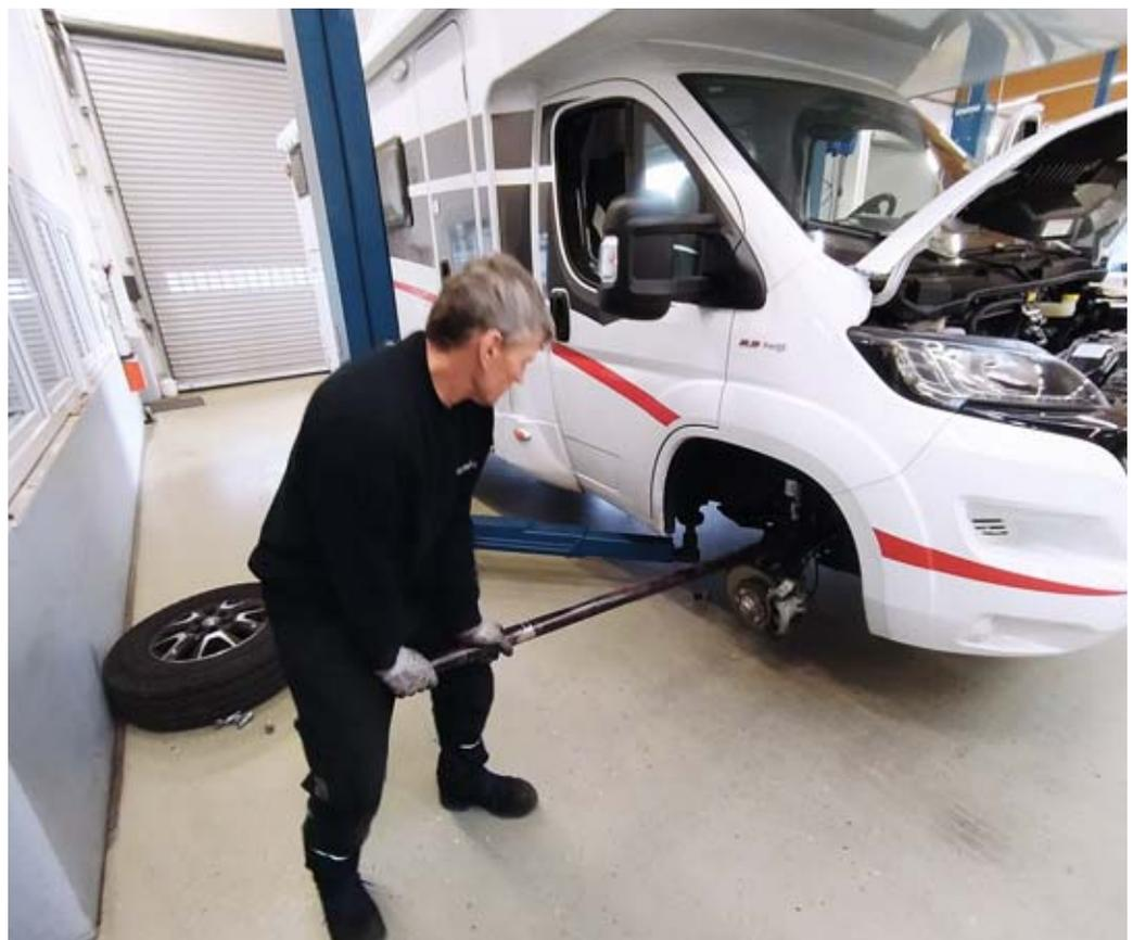
*Mit Spezialwerkzeug wird das Federbein von der Vorderachse des Ducatos getrennt.*
