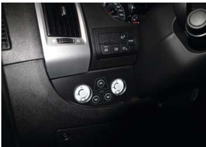
Am Bedienteil im Cockpit kann der Druck in den Luftbälgen individuell geregelt werden.
