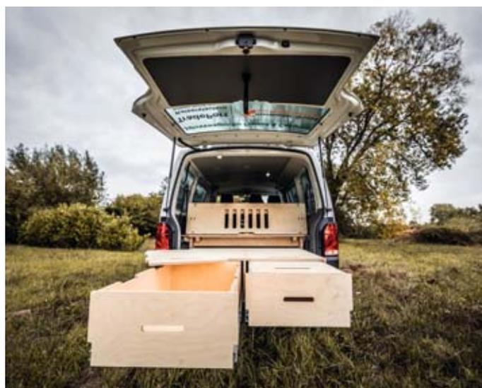
Die Ausbauteile von Hornbach sind passgenau für gängige Kastenwagen verfügbar und aus Birkenperrholz gefertigt.
