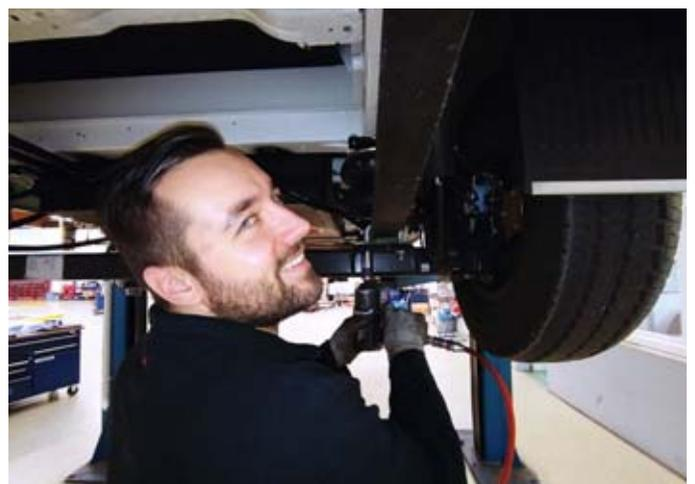
Goldschmitt-Monteur Rico Schöllhammer bei der Montage der Zusatzluftfederung an der Hinterachse des Reisemobils.
