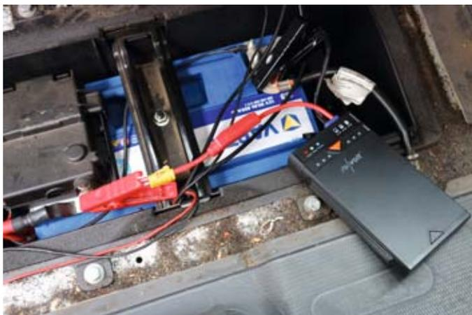
Über die Klemmen versorgt die Starthilfe die Batterie mit Strom.
