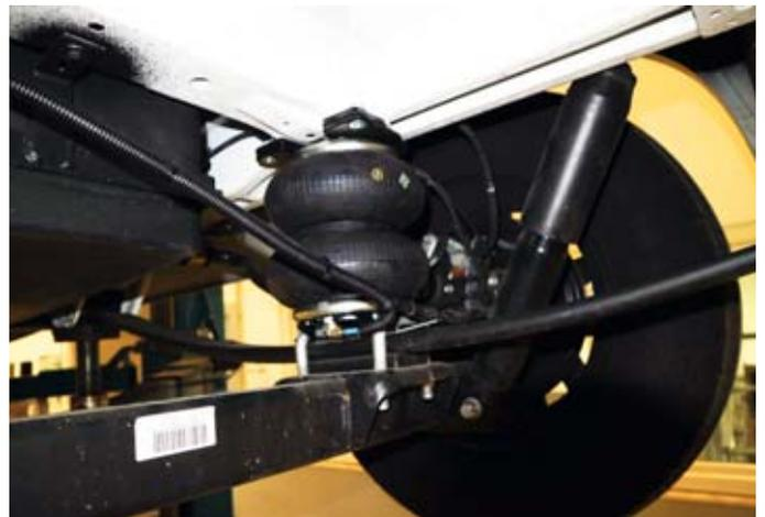
Kräftige Gummibälge übernehmen an Stelle der klassischen Stahlfeder die Federung an der Hinterachse. Das Ergebnis ist eine deutliche Steigerung des Fahrkomforts.
