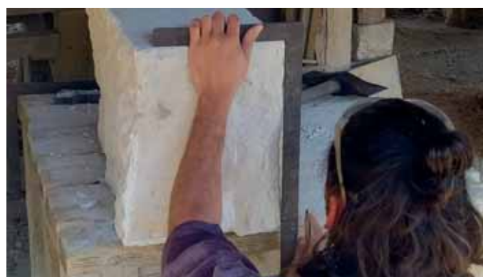
Passt der Stein? Der Steinmetz überprüft mit einem Winkel das Ergebnis seiner Arbeit.
