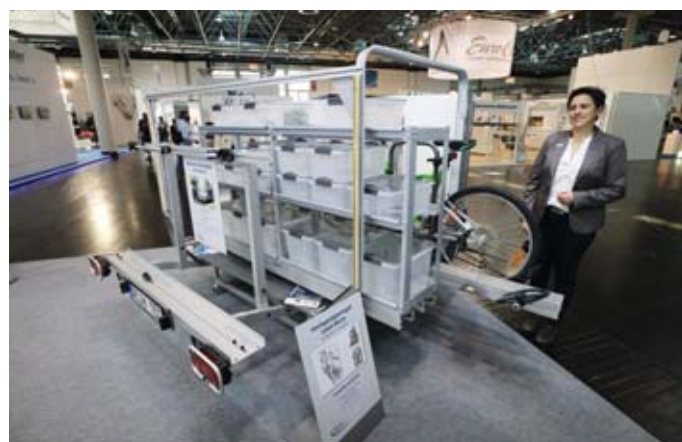
Das System von Weih-Tec sorgt für Ordnung in der Heckgarage. Es ist nach beiden Seiten ausziehbar.
