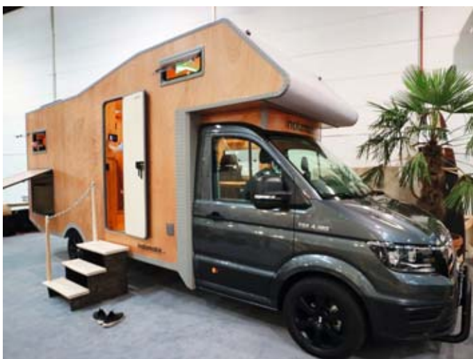
Ein Reisemobil der etwas anderen Art: Das Modell aus dem Schwarzwald hat einen hölzernen Aufbau. Die Hülle ist aus wetterfestem Bootsbausperrholz.
