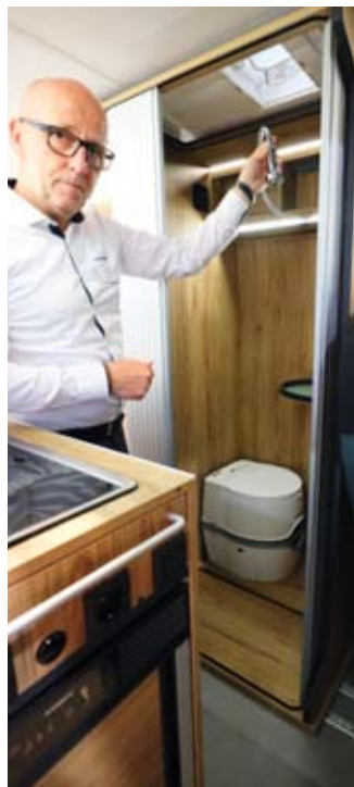
Die Nasszelle ist herausnehmbar und verschiebbar.
