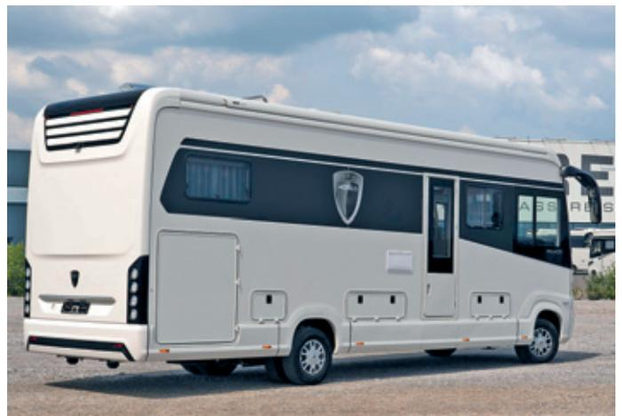
bare Garage bietet Platz für Fahrräder, Roller oder – beim G-Modell – für einen Smart. Der beheizbare Doppelboden ist über Außenklappen zugänglich und bietet mit einer Höhe von 420 Millimeter zusätzlichen Stauraum für Gepäck. Temperiert wird das Fahrzeug über eine Alde-Warmwasserheizung mit serienmäßiger Fußbodenheizung, Handtuch-Heizkörper und separat regelbarem Heizkreislauf für Schlafzimmer und Garage. Die neue Eingangstür mit XL-
