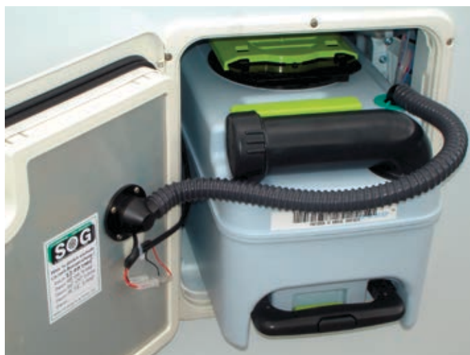
Der Schlauch sorgt für die Luftzufuhr ins Innere der Toilettenkassette.
