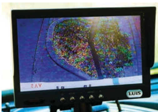
Der Nahbereich ist gut zu erkennen – auch bei schwierigen Lichtverhältnissen. Die weiße Kante unten ist der hintere Stoßfänger des Reisemobils.
