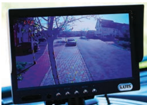
Der Sieben-Zoll-Monitor fungiert auch als komfortabler elektronischer Rückspiegel. Er zeigt in klaren Bildern das Geschehen im Heck des Reisemobils.
