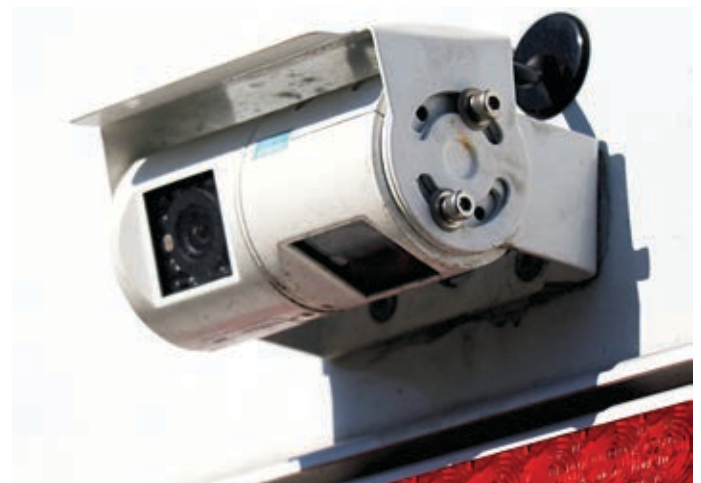
Ein stabiles Gehäuse schützt die beiden Luis-Rückfahrkameras.
