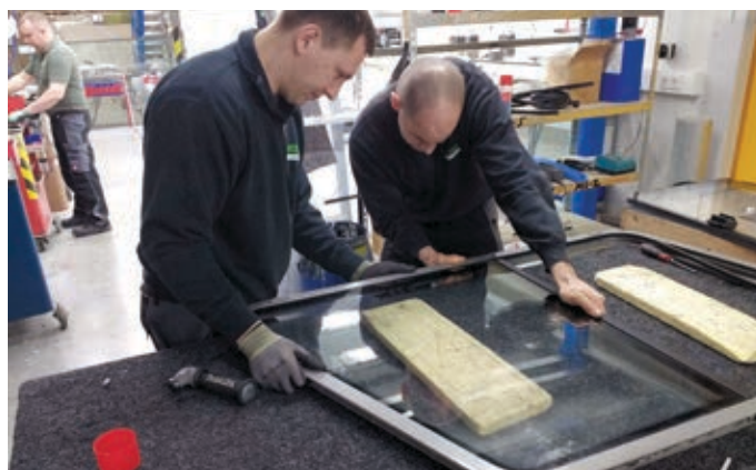
Die neue Scheibe wird in den Rahmen eingepasst und abgedichtet.
