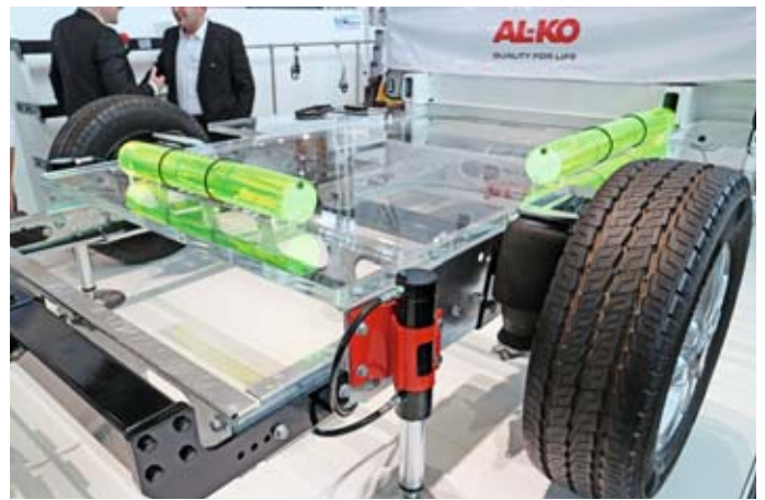
AL-KO präsentierte eine neue Hubstützengeneration für den Fiat-Ducato.
