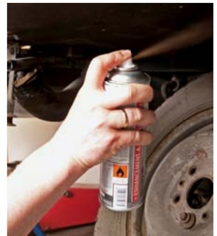
Mit Unterbodenschutz aus der Sprühflasche kann das Mobil gut von unten versiegelt werden.
