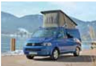
Die aktuelle Modellgeneration: der VW California Comfortline mit elektrohydraulisch ausfahrbaren Aluminium-Aufstelldach.
