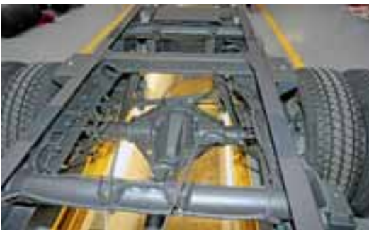
Alt und Neu: Das neun Jahre alte Fahrgestell war ziemlich angegriffen und rostig. Das neue wurde mit Unterbodenschutz optimal auf die tragende Aufgabe vorbereitet.
