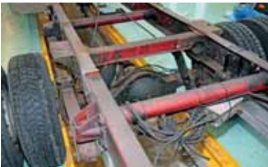
Anpassungsarbeiten sind notwendig, um die Kabine auf das neue Fahrgestell aufsetzen zu können.
