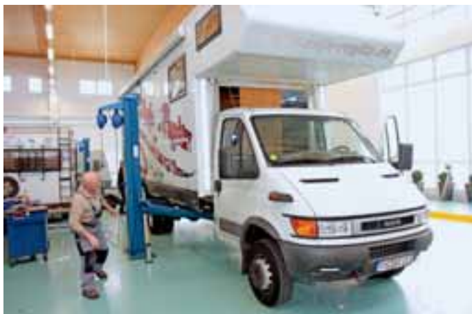
Das Ende einer Reisemobil-Ehe: Die Phoenix-Kabine wird vom alten Iveco-Fahrgestell getrennt.
