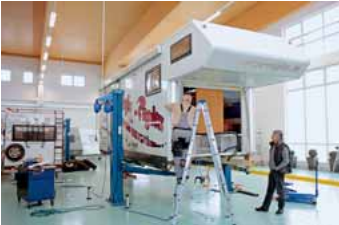
Anpassungsarbeiten sind notwendig, um die Kabine auf das neue Fahrgestell aufsetzen zu können.
