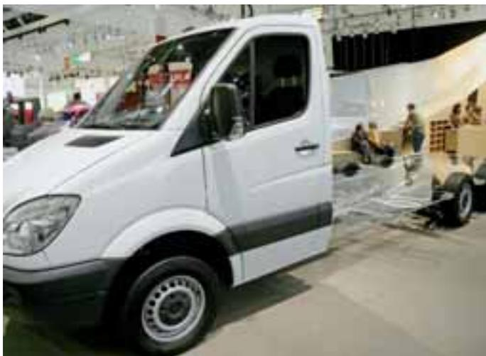
**Mercedes** zeigte ein Sprinter-Dreiaxsfahrgestell für sechs Tonnen Gesamtgewicht und ein Sprinter-Demonstrationsmodell mit einem Vergleich des normalen Rahmens zum Tiefrahmen.
